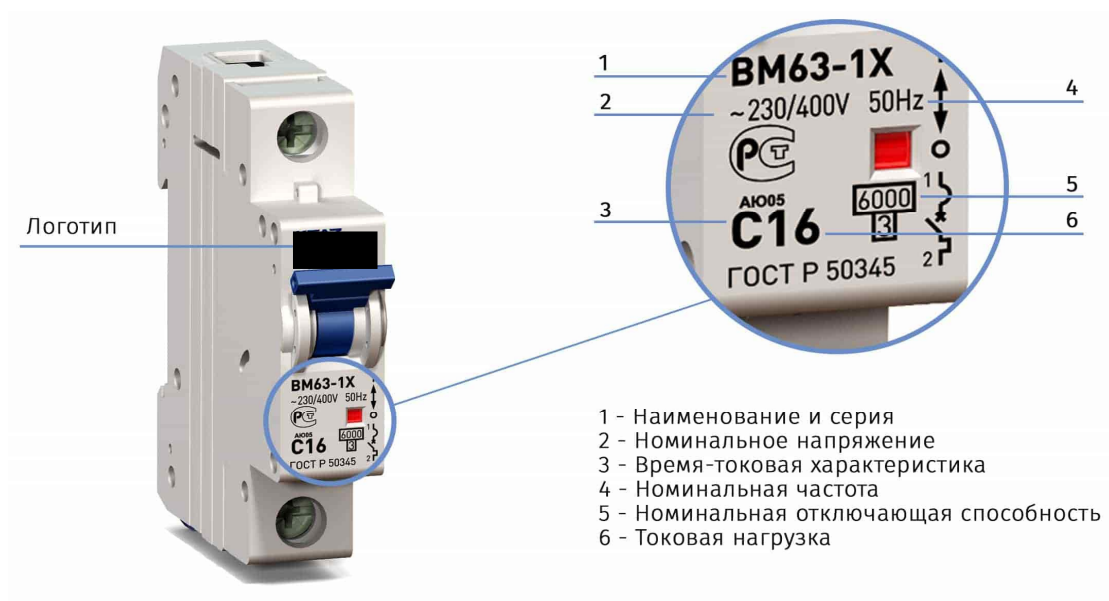
Рисунок 2. Пример маркировки АВ
