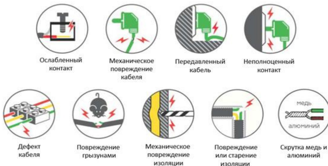
Рисунок 6. Возможные причины искрения в электропроводке
